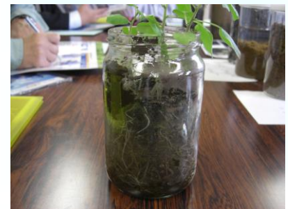
浚渫改良土の植物成長状況
